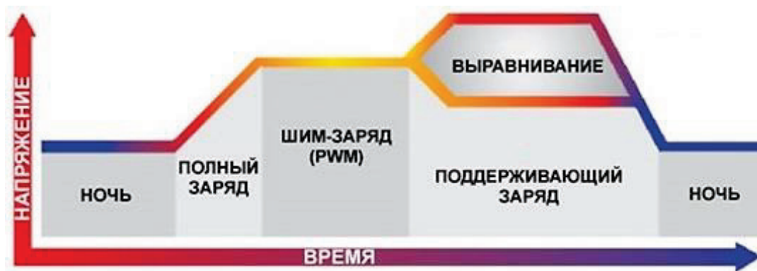
Рис. 1.21. Стадии заряда аккумуляторной батареи от солнечной панели
