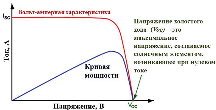
Рис. 1.7. Вольт-амперная характеристика солнечного элемента и напряжение холостого хода
